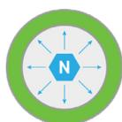
Les nutriments encapsulés sont dissous, mais pas libérés, ce qui entraîne une augmentation de la pression à l'intérieur du granulé
